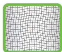
Обычный фильтр (размер пор: 1,2×1,2 мм)
